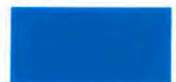
Azul Munsell 2,5 PB 4/10 / Azul 40010 - Identifica andaimes, escadas, equipamentos fora de serviço (em manutenção) / Identificar los andamios, escaleras, equipos fuera de servicio (en mantenimiento).
