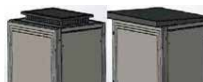
Detalle de techo ventilado y protector
