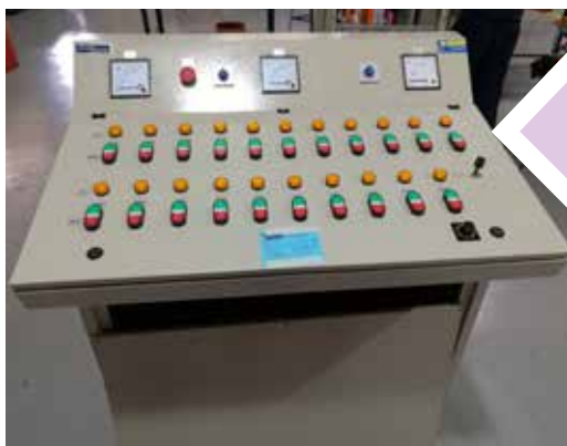
Mesa de comando para 21 motores Aplicación: Industria Cerámica
