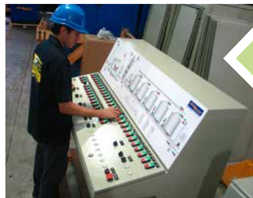
Mesa de comando para 21 motores Aplicación: Industria Cerámica
