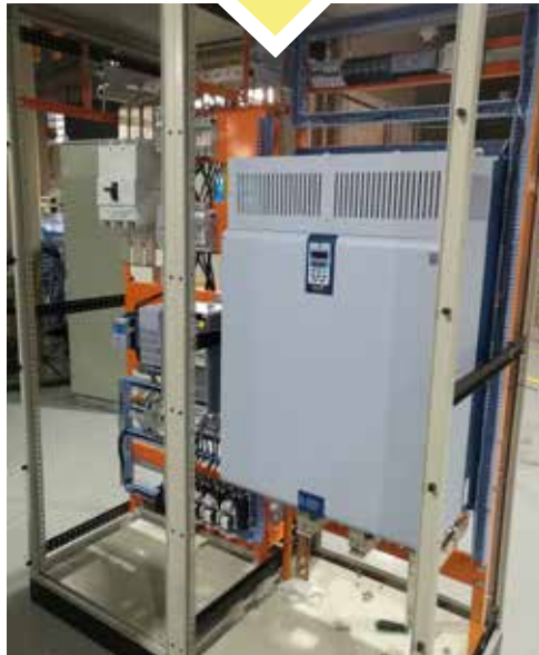
Arrancador Suave para 600HP Aplicación: Chipeadora
